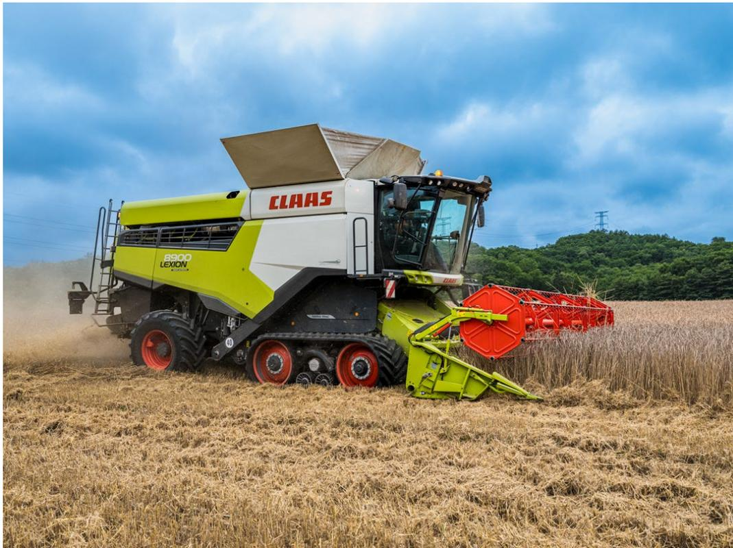
これはドイツにある欧州最大規模の農業機械メーカーのコンバインで、コンバインハーベスター（複式収穫機）と呼ばれるもの。日本では最大級のコンバイン。穀物の刈り入れから脱穀・選別を同時に行うことができる。乗り心地はとてもいい。
